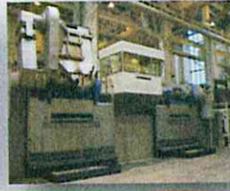
Příklad indukční cívky pro tavicí pec na 4t šedé litiny
