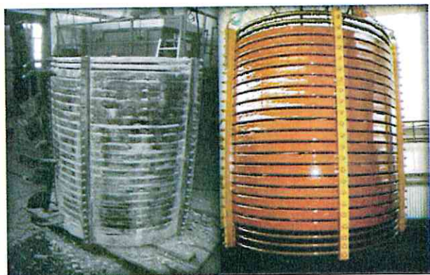
Příklad indukční cívky pro tavicí pec na 4t šedé litiny
